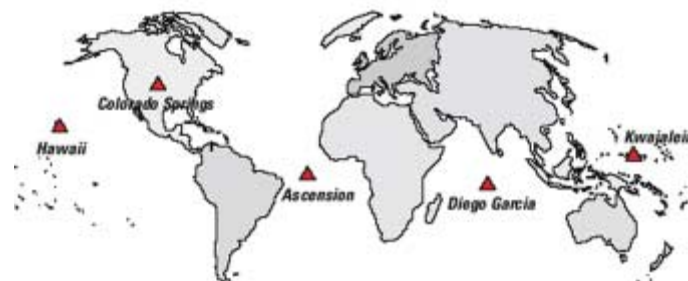
ILUSTRACIÓN 8. Estaciones de control del sistema GPS. (Leica)
